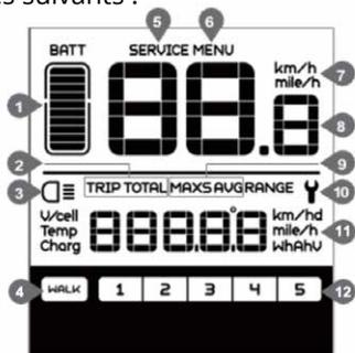
1. Affichage en temps réel de la capacité de la batterie
