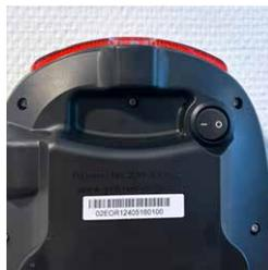
4. Il y a aussi un bouton marche/arrêt sous la batterie, si vous éteignez cet interrupteur, la batterie ne fonctionnera pas dans le vélo.
